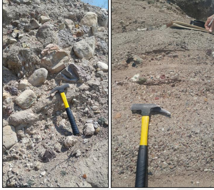
Şekil 4.20 Güllüoluk ÖSK'ya ait tane destekli masif konglomeralar (solda; F2 fasiyesinden istifin 15.m'den alınmış) ve ince taneli matriks destekli masif konglomeraların (sağda) arazi görünümü
