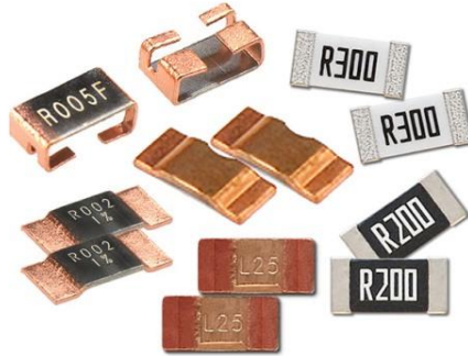
Şekil 2.25. Akım ölçümünde kullanılan şönt direnç tipleri
