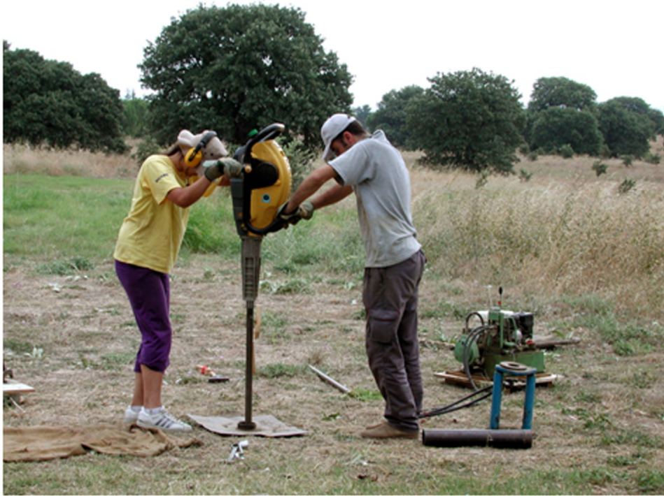
Fig. 5. Cobra delici ile yapılan çakma-delgi sondaj (percussion drilling) çalışmaları.
