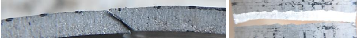
(a) AA7075, 500 °C de 2 saat çözünmüş numune kırılma yüzeyi yandan ve üstten görünüm
