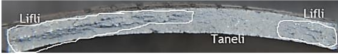
(b) AA7075, 500 °C de 2 saat çözünmüş numune kırılma yüzeyinin lifli ve taneli görünümü.
