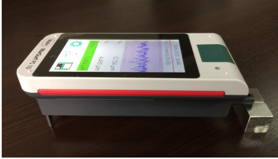
Şekil 4. EEİ yöntemiyle delinmiş işparçası yüzeyinin Mahr MarSurf PS 10 cihazıyla yüzey pürüzlülüğü ölçümü
