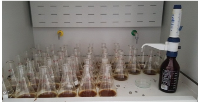
FotoĖraf 12.  eker ocakta sedimentler  zerine kimyasalların eklenmesi. Photo 12. Addition of chemicals on sediments in a fume hood.
