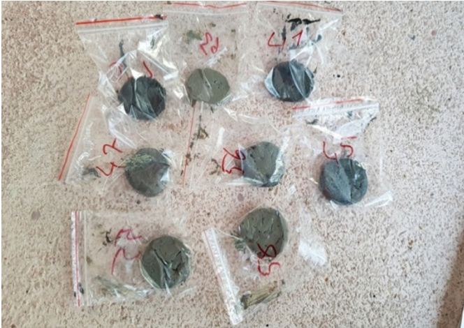
FotoĖraf 7. 1 cm'lik dilimlenmiř karot   rnekleri. Photo 7. 1 cm sliced core samples.
