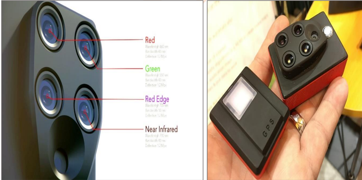
Şekil 65 Parrot Spektral kamera algılayıcıları ve boyutları
